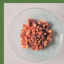
Hydrogel na bázi karboxymethylcelulózy a kyselá syrovátka, síťovací činidlo kyselina citrónová
